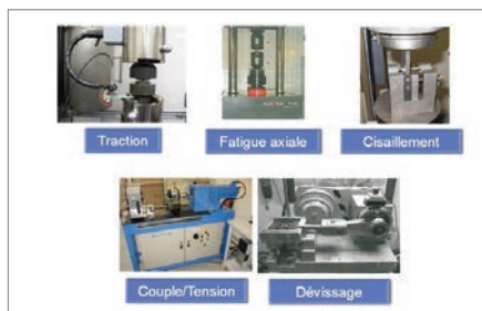
Machines d'essais pour caractérisation des connecteurs (LISI Aerospace)
